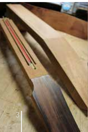
専用の機械で板材を熱して曲げ、型枠に固定して本体を組み立てる。写真の黒い木材は指当りの板に使われる黒檀(こくたん)、左端写真の茶色の木材はマホガニー。いずれも古くから使われていたが近年、ワシントン条約で取引が禁止され新たな入手は不可能となっている
