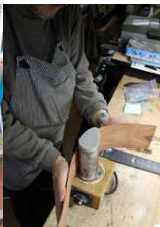
専用の機械で板材を熱して曲げ、型枠に固定して本体を組み立てる。写真の黒い木材は指当りの板に使われる黒檀(こくたん)、左端写真の茶色の木材はマホガニー。いずれも古くから使われていたが近年、ワシントン条約で取引が禁止され新たな入手は不可能となっている
