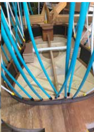
専用の機械で板材を熱して曲げ、型枠に固定して本体を組み立てる。写真の黒い木材は指当りの板に使われる黒檀(こくたん)、左端写真の茶色の木材はマホガニー。いずれも古くから使われていたが近年、ワシントン条約で取引が禁止され新たな入手は不可能となっている
